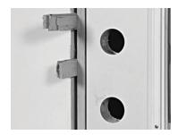
Fixer le jambage de chaque côté, à environ 8" de haut et du bas du cadre. Installer des cales jusqu'à ce que il y ait 1 / 8 d'écart entre le chambranle et le bord de la dalle porte sur toute la longueur de la porte. Caler au niveau de la poignée juste au- dessus et en dessous du trou, toujours garder 1/8" tout le tour. Tirez le coupe-froid loin du chambranle et viser en utilisant une vis de 3" .Viser à travers le cadre de bois (chambranle), les cales et dans le cadre extérieur.
